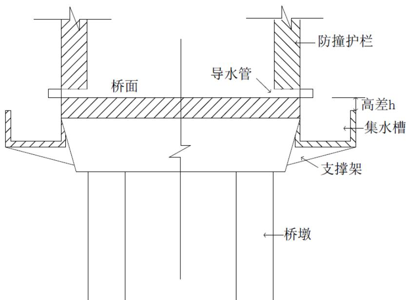
图 5.6-9 桥面纵向排水系统剖面示意图
