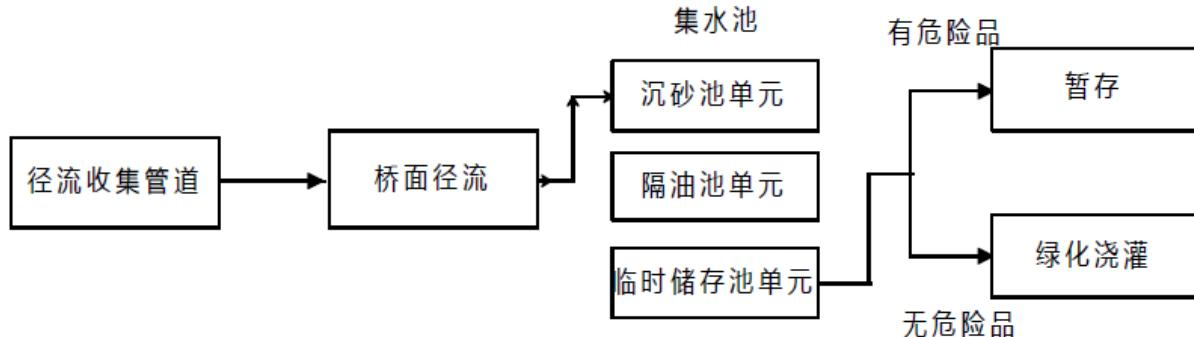
图 5.6-10 桥面径流收集处理工艺流程图
