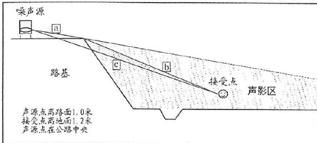
图 4.3-3 声程差  $\delta$  计算示意图
