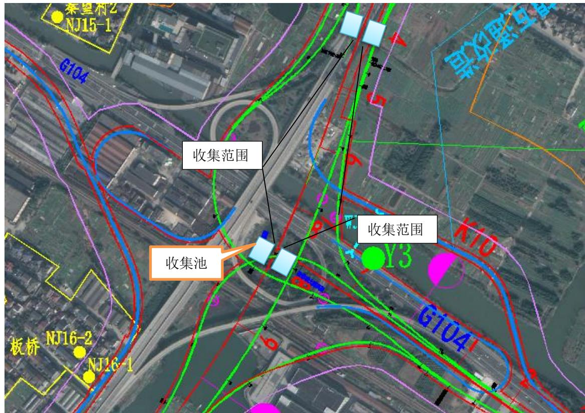
图 5.6-4 项目新秦望互通主线桥 1 跨越浙东运河收集系统平面布置图
