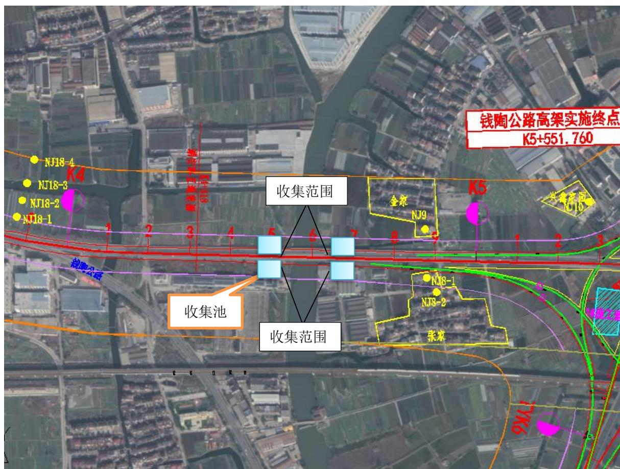
图 5.6-1 项目钱陶公路高架主线桥跨越东小江收集系统平面布置图
