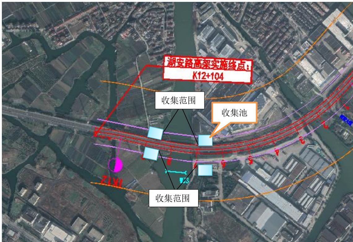
图 5.6-8 项目跨越柯夏线收集系统平面布置图
