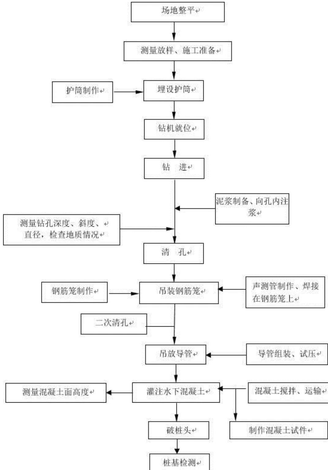
图 2.5-1 钻孔灌注桩施工工艺流程框图
