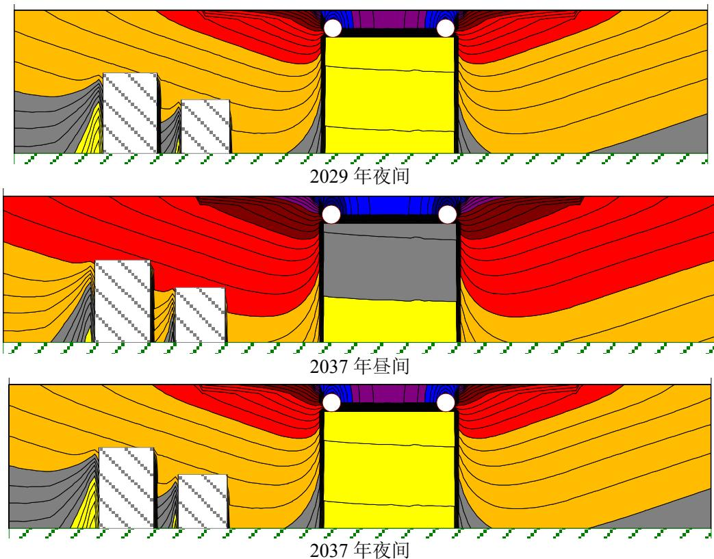
图 4.3-7 沿线典型敏感建筑垂直声场等声级线图
