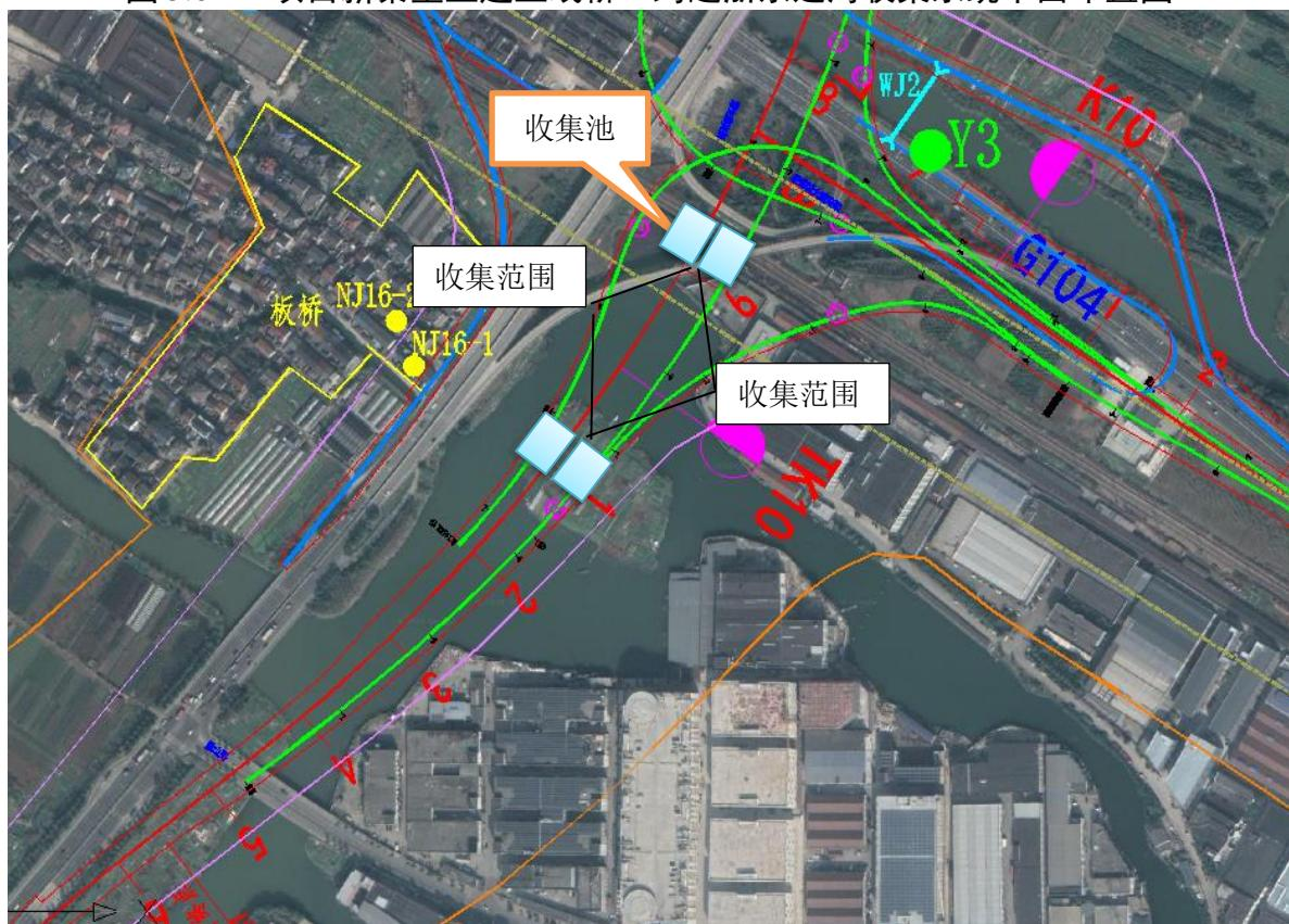
图 5.6-5 项目新秦望互通主线桥 2 跨越南塘河收集系统平面布置图
