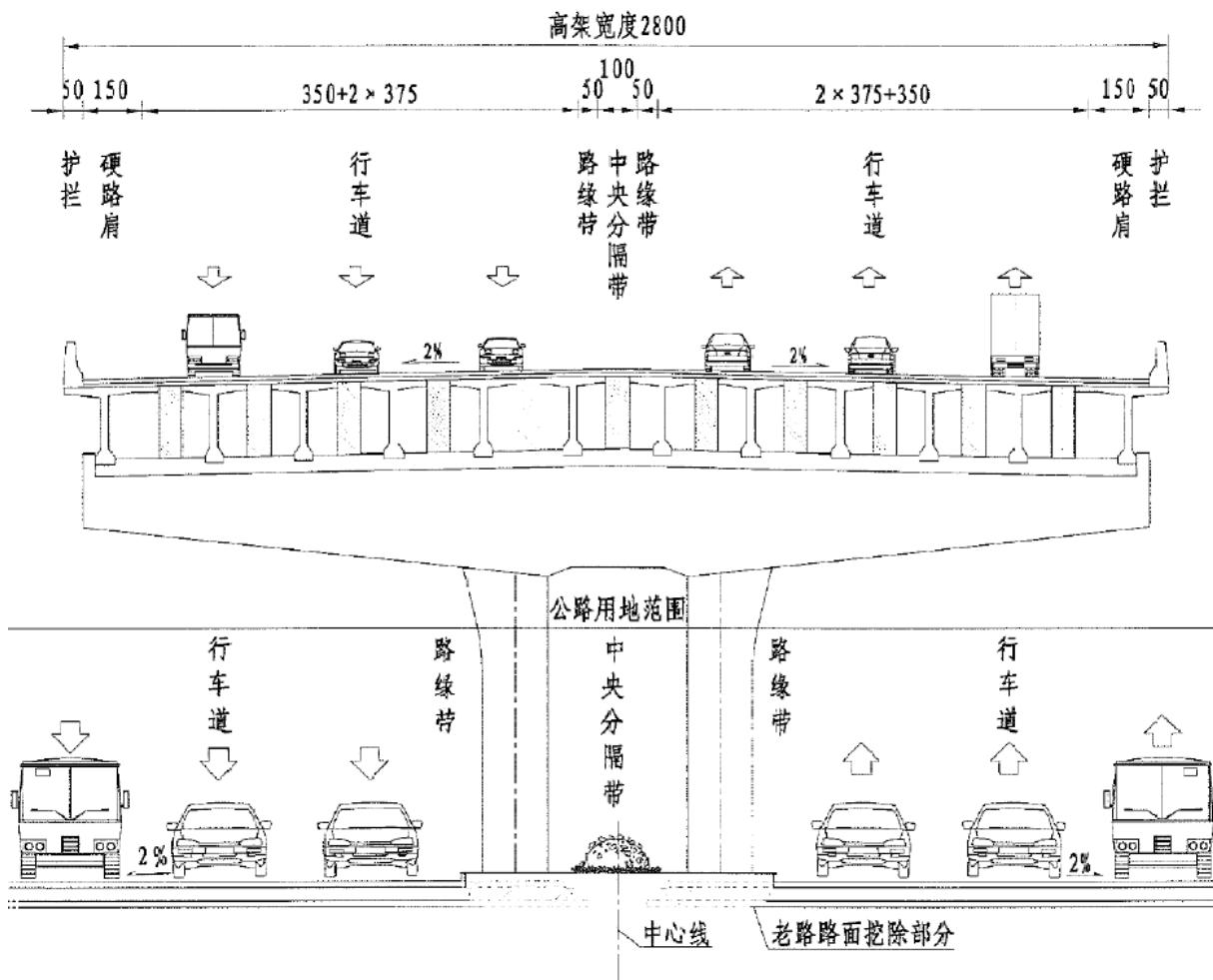
图 2.4-2 湖安路高架段标准横断面图
