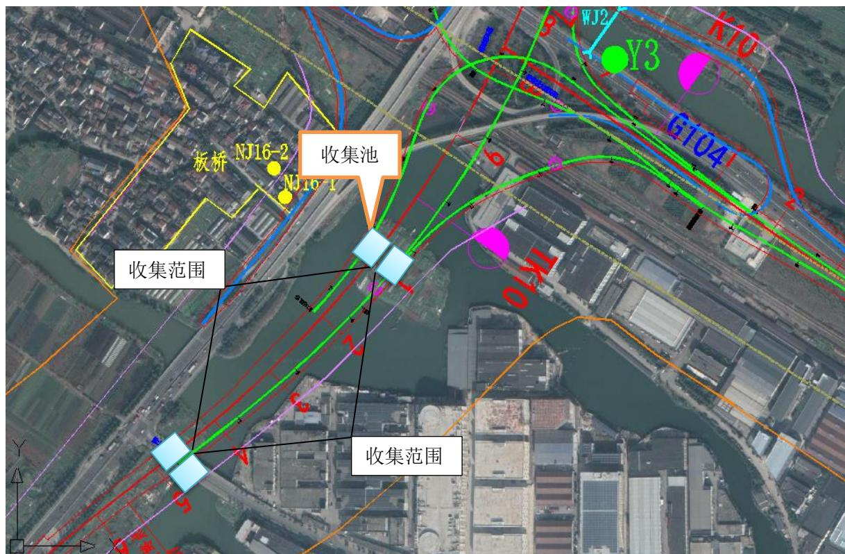
图 5.6-6 项目新秦望互通主线桥 3 跨越南塘河收集系统平面布置图
