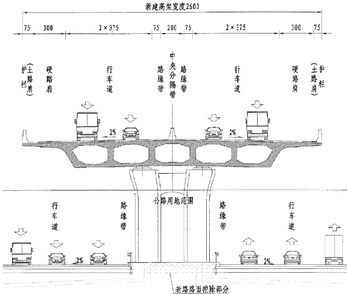
图 2.4-3 轻纺城大道高架段标准横断面图
