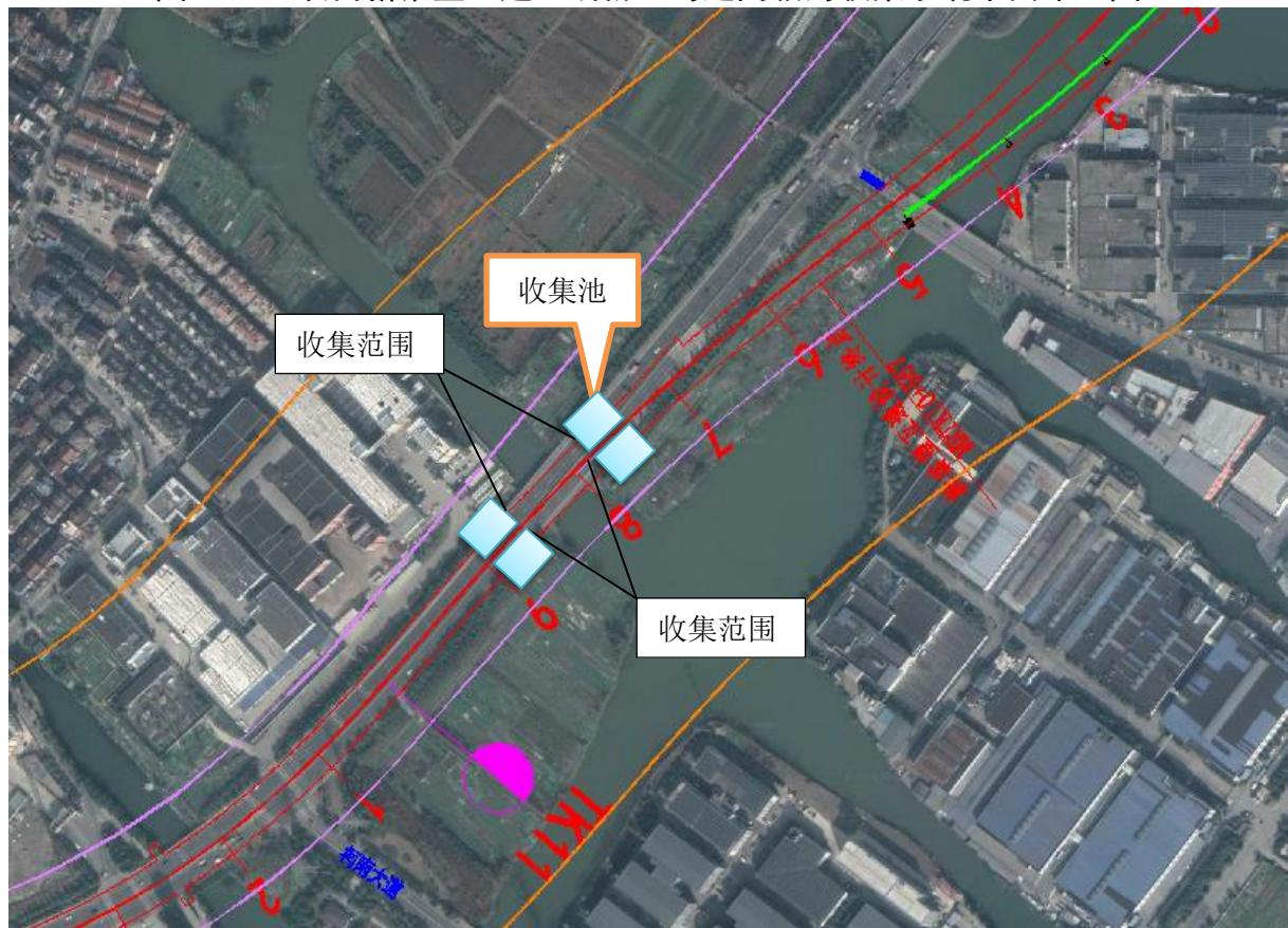
图 5.6-7 项目湖安路高架主线桥 3 跨越南塘河收集系统平面布置图
